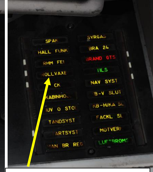
ROLL VÄXEL: Roll Gearing system failure
